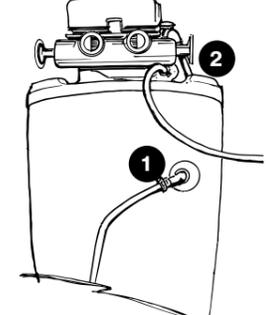
**RACCORDEMENT DES TUYAUX EVACUATION ET TROP-PLEIN**
